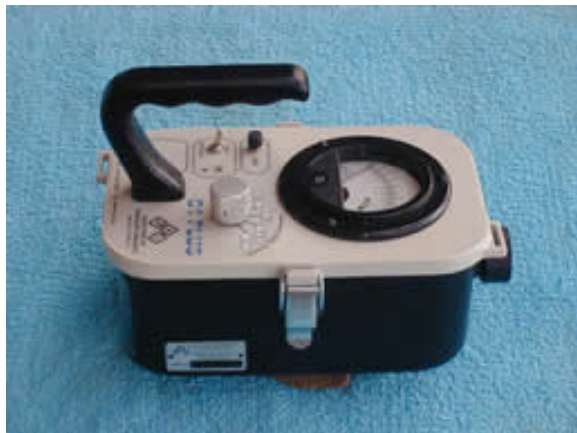
Medidor com detector interno tipo Geiger- Müller. Detecta radiações do tipo \alpha (alfa) > 4 MeV, \beta (beta) 100 keV, \gamma (gama) e raios X > 50 keV.
