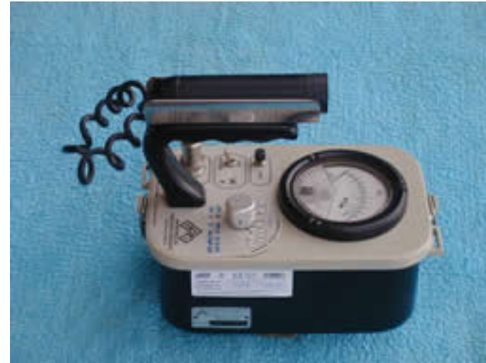
Medidor com detector fixo externo tipo Geiger Müller. Detecta radiações do tipo \alpha (alfa) > 4 MeV, \beta (beta) 100 keV, \gamma (gama) e raios X > 50 keV.
