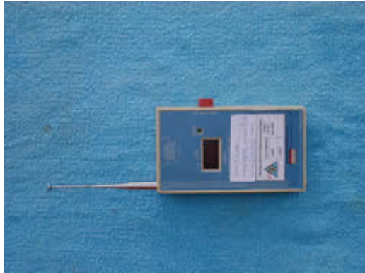
Medidor com detector interno tipo Geiger-Müller. Detecta radiações do tipo \gamma (gama) > 50 Kev.
